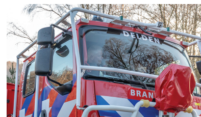
Elektrisch aangedreven zelfprotectiesysteem
